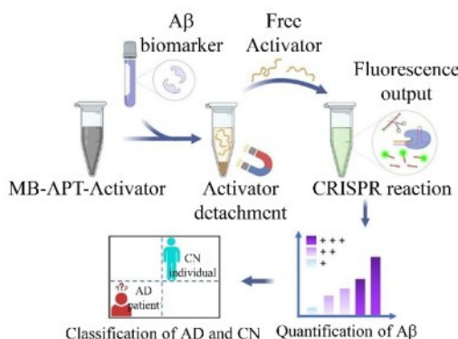
(a) CRISPR的适体传感器用于定量检测临床脑脊液样本中的A \beta 生物标志物及对患者进行诊断分类 [66]
